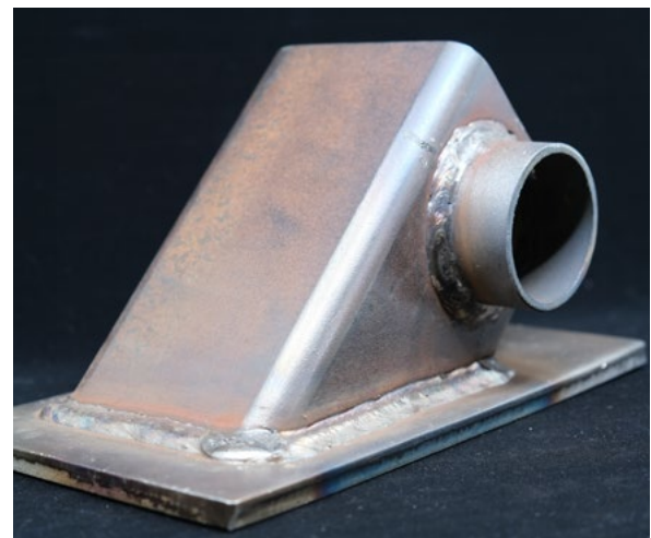
Demonstrator zum Schweißen mit selbstschützendem Fülldraht.
