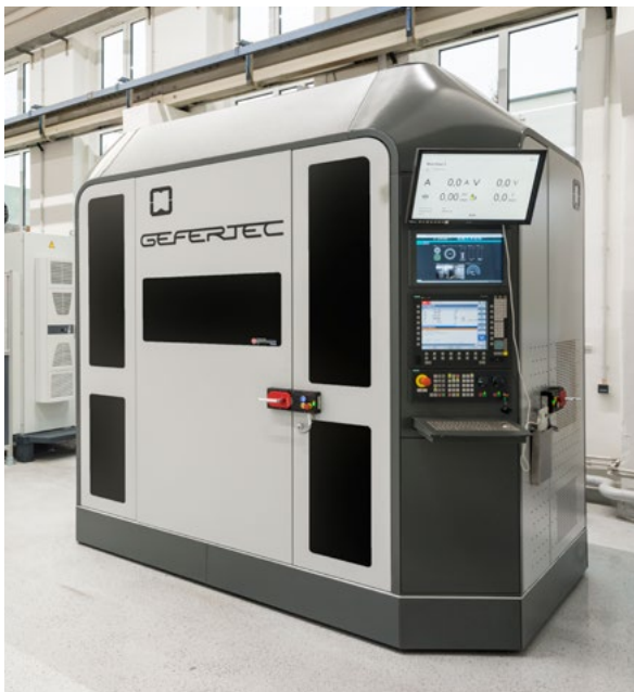
Neue Anlage zur Generierung metallischer Großstrukturen.
