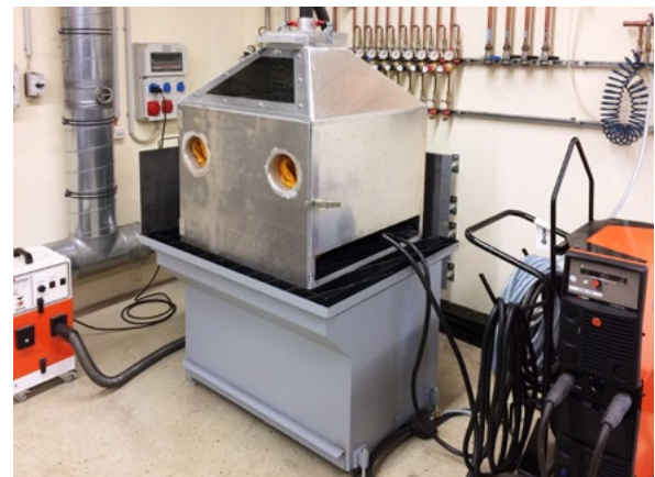
Versuchsstand mit Fume-Box zur Schweißraucherfassung.
