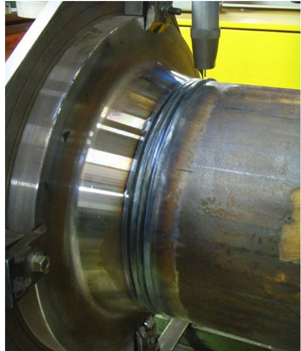
Verbindungsschweißung einer plattierten Rohr-Flanschverbindung.
